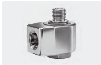
3/8" IG : 1/4" AG. DN 7. Max. 150 bar / 30 U/min / 90 °C
