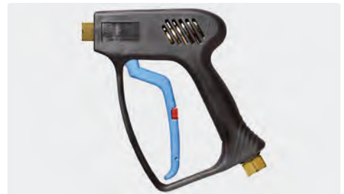
Professionelle Pistole. Frostschutzausführung. Max. 275 bar / 45 l/min / 150 °C
