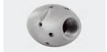
3/4" IG. 6x 75° 3x 30° +1x 0°. 100-250 l/min. Für \text{R} \text{Ø} 150-300 mm. Außen \text{Ø} 50 mm. \text{Ø} 1.367 g.
