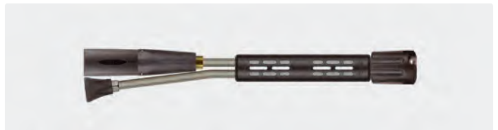
Schaumdoppellanze mit Isolierung ST-9 205 mm, Umschaltventil ST-58, Düsenschutz ST-10 ohne Düse und Schaumkopf ST-75.1 ohne Düse. Es wird ein Schauminjektor benötigt. Max. 350 bar / 45 l/min / 100 °C
