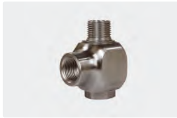
1/2" IG : 1/2" AG. DN 12. Max. 30 U/min / 90 °C
