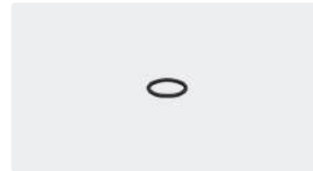
O-Ring. TYP SP-20. 13,1x2,6. Max. 250 bar / 100 °C
