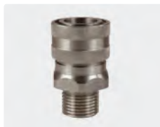
Kupplung : AG. Edelstahl. 60° Dichtkonus. Max. 250 bar / 150 °C
