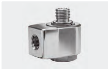
1/4" IG : 1/4" AG. DN 7. Max. 150 bar / 30 U/min / 90 °C
