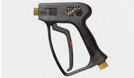
Professionelle Pistole. Max. 275 bar / 45 l/min / 150 °C
