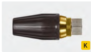
M18 IG. Spritzwinkel 20°. 100 - 250 bar. Max. 100 °C
