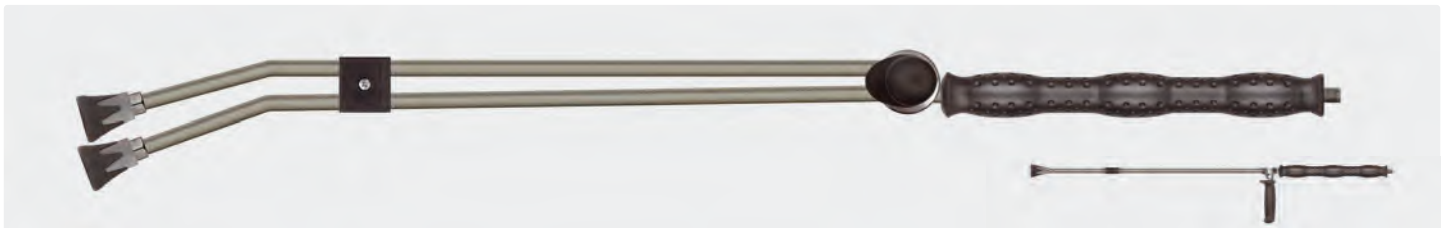
1" AG. Strahlrohr mit Isolierung ST-29 Cool & Compact, Ventil ST-54.2 seitlich und Düsenschutz ST-10 mit Niederdruckdüse. Max. 400 bar / 150 °C
