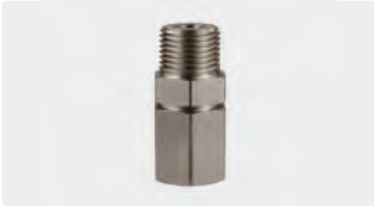
1/2" AG : 1/2" IG. Edelstahl. Max. 350 bar / 90 °C
