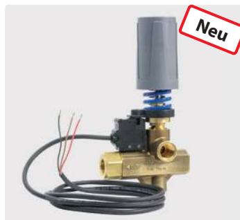
☉ = Eingang 3/8" IG. ☉ = Ausgang 3/8" IG. [BP] = Bypass 3/8" IG. Kugel-Rückschlagventil. Umlaufventil mit Schalter (IP 6K7) und Kabel 1.200 mm. Max. 350 bar / 80 °C
