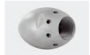
1" IG. 8x 75° +1x 0°. 100-250 l/min. Für \text{R} \text{Ø} 150-300 mm. Außen \text{Ø} 62 mm. \text{Ø} 1.265 g.
