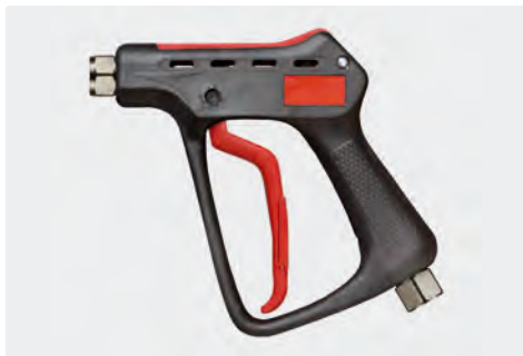
Professionelle Höchstdruckpistole. Max. 600 bar / 80 l/min / 150 °C
