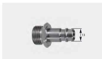
Stecknippel : AG. Edelstahl. Max. 150 bar / 90 °C
