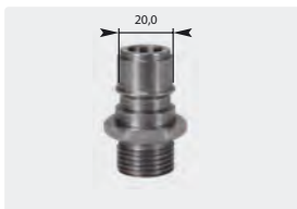
Stecknippel : AG. Edelstahl ungehärtet. Max. 250 bar / 150 °C
