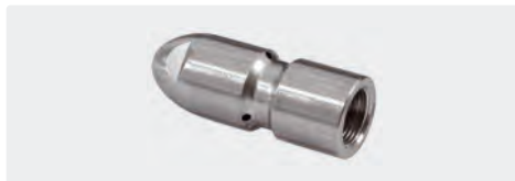
M7x0,5 IG. Bohrungen nach hinten für optimalen Vortrieb und kraftvolles Reinigen. Außen \varnothing 9,8 mm. Edelstahl. Max. 500 bar
