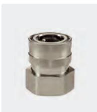
ST-45. Messing vernickelt. Kupplung : 1" IG. 25 bar / 90° C
