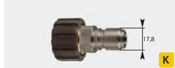
Stecknippel : IG. Edelstahl + Messing. Max. 250 bar / 150 °C
