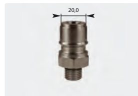
Stecknippel : AG. Edelstahl gehärtet. Max. 250 bar / 150 °C
