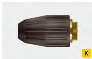
M18 IG. Spritzwinkel 20°. 200 - 350 bar. Max. 100 °C
