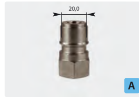
Stecknippel : IG. Edelstahl. Max. 250 bar / 150 °C
