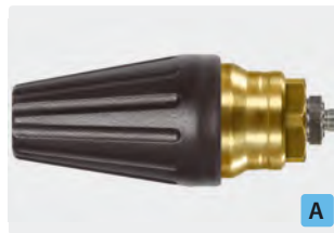
1/8" AG. Spritzwinkel 20°. 200 - 400 bar. Max. 100 °C
