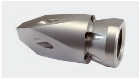
300 bar. 1/2" IG. \square 68 mm, \varnothing = 31 mm, \boxtimes 0,17 kg. Für Rohre > 60 mm. Seitliche Frontstrahlen mit gehärteten Edelstahl Düseneinsätzen.
