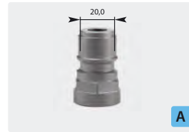
Stecknippel : IG. Edelstahl gehärtet. Max. 250 bar / 150 °C
