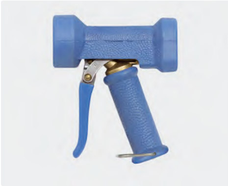
Pistole mit stufenloser Spritzwinkelveränderung. Max. 24 bar / 100 l/min / 50 °C
