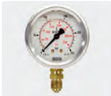
Ø 63 mm. 1/4" AG. Gehäuse Edelstahl. Eingang unten. Typ WIKA
