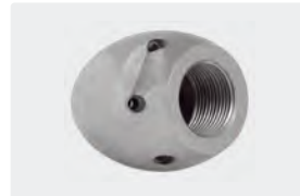
3/4" IG. 6x 75° +1x 0°. 30-100 l/min. Für \text{R} \text{Ø} 120-250 mm. Außen \text{Ø} 50 mm. \text{Ø} 567 g.
