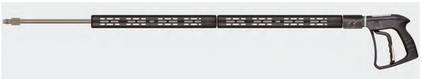
Professionelle Dampfpistole ST-4000 Weep mit Lanze aus Edelstahl, Isolierung ST-9 380 mm und Dampf-Niederdruckdüse aus Edelstahl. Max. 20 bar / 200 °C
