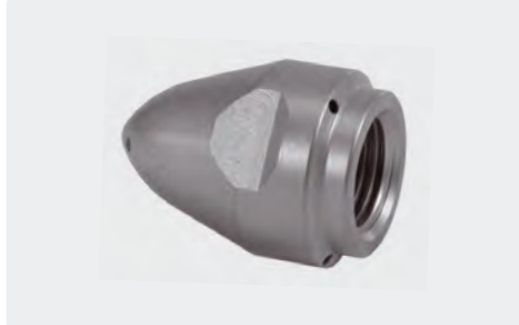
Außen \varnothing 22 mm Gehärteter Edelstahl. Max. 500 bar / 32 l/min.
