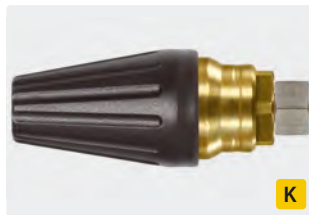
M18 IG. Spritzwinkel 20°. 200 - 400 bar. Max. 100 °C
