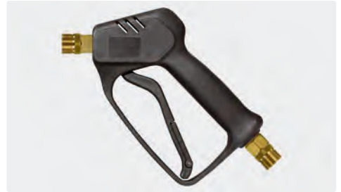
Professionelle Pistole. Max. 210 bar / 25 l/min / 150 °C
