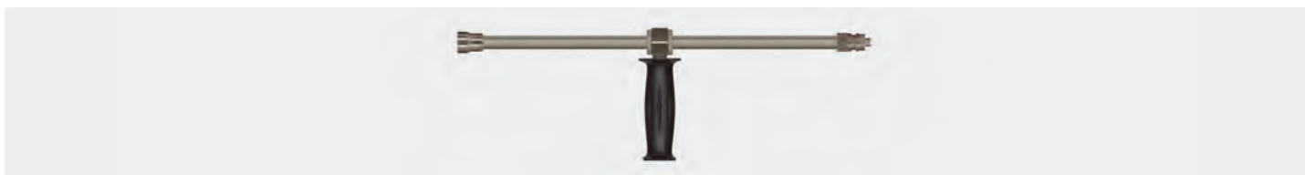
Stecknippel ST-45. Strahlrohr mit Handgriff und Muffe 1/4" IG NPT aus Edelstahl ohne Hochdruckdüse. Max. 600 bar / 150 °C
