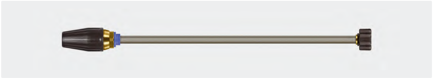
HV M22. Strahlrohr mit Rotordüse ST-357.1. Spritzwinkel 20°. 100 - 250 bar. Max. 100 °C
