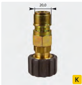
Stecknippel : IG. Stahl verzinkt + Messing. Max. 250 bar / 150 °C
