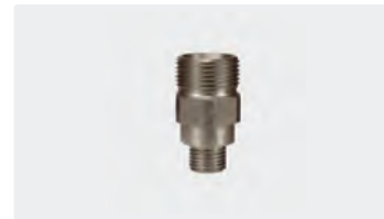
M22 AG : 1/4" AG. Langbohrung. Max. 400 bar / 150 °C
