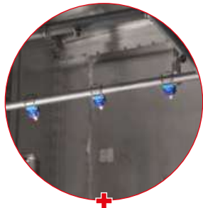
Einstellbare Düsen für die Außenreinigung von IBC-Containern
