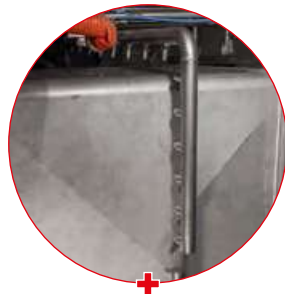
Abblasdüsen für IBC-Container-Außentrocknung
