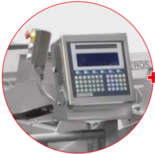
Bildschirm-Terminal mit Rezeptspezifikationen (Zutatenmengen)
