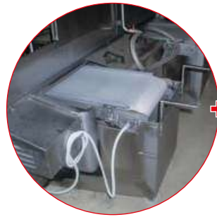
Bandfilter zur Entfernung von Partikeln größer als 2 mm 2
