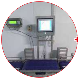
Kontrollstationen (I- und C-Punkte) zur Sortierung des Materials (optional)
