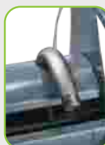
Schutz vor Schlauchknick durch Edelstahl-Zulaufrohr
